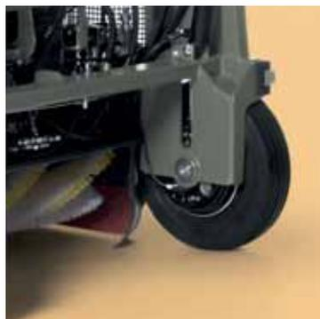
Le ruote di grande diametro oltre a ridurre le sollecitazioni meccaniche favoriscono anche il confort. Il loro supporto robusto contribuisce a mantenere inalterate le caratteristiche di funzionamento. Entrambe le versioni sono equipaggiate di serie con freni a comando idraulico
