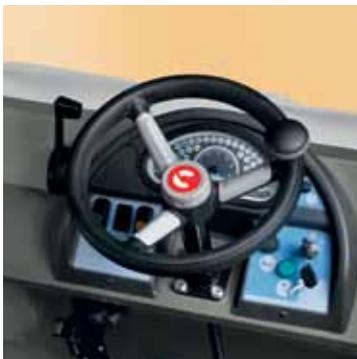
CS80/90/110 adottano un cruscotto di nuova concezione, di tipo automobilistico, con visualizzazione immediata di tutte le funzioni. Lo sterzo, di nuova concezione, è studiato per rendere estremamente confortevoli le operazioni di guida
