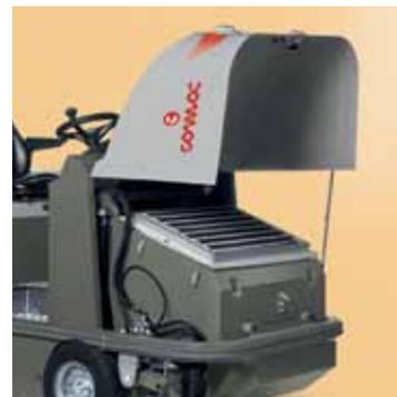
Il semplice controllo dell'olio o cambio filtri, ad es., nella versione motorizzata sono stati ridotti ad una facilità estrema. Nella versione B la cassetta che ospita i dispositivi elettrici è posizionata nella zona centrale in modo da permettere un facile e rapido controllo degli stessi e del livello del liquido negli elementi delle batterie. È possibile prevedere l'installazione del cassone batterie con capacità fino a 480 Ah C5 (versione CS90B-CS110 B)
